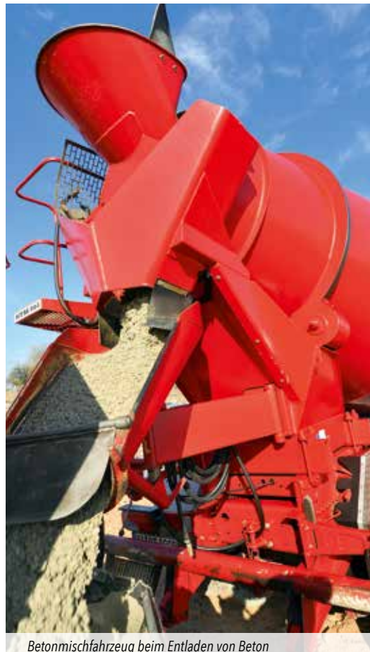
Betonmischfahrzeug beim Entladen von Beton
